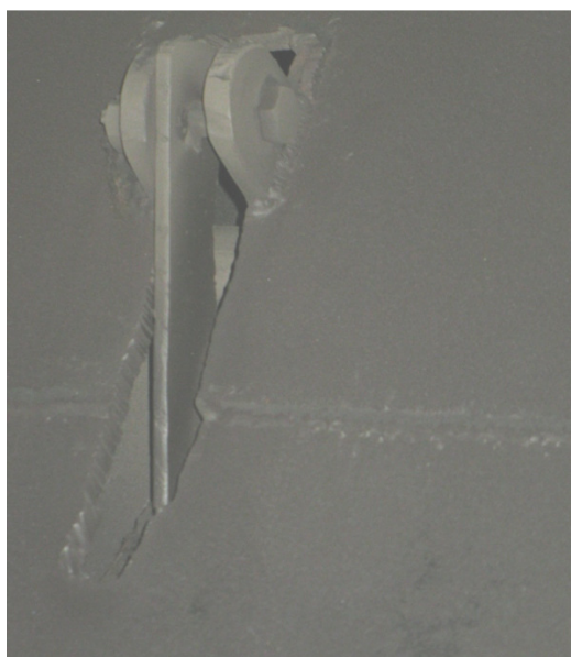
Rys. 7.6 Wycięcie w górnej łopacie odsiewacza młyna 1 (mniejsze niż w młynie nr 3)
