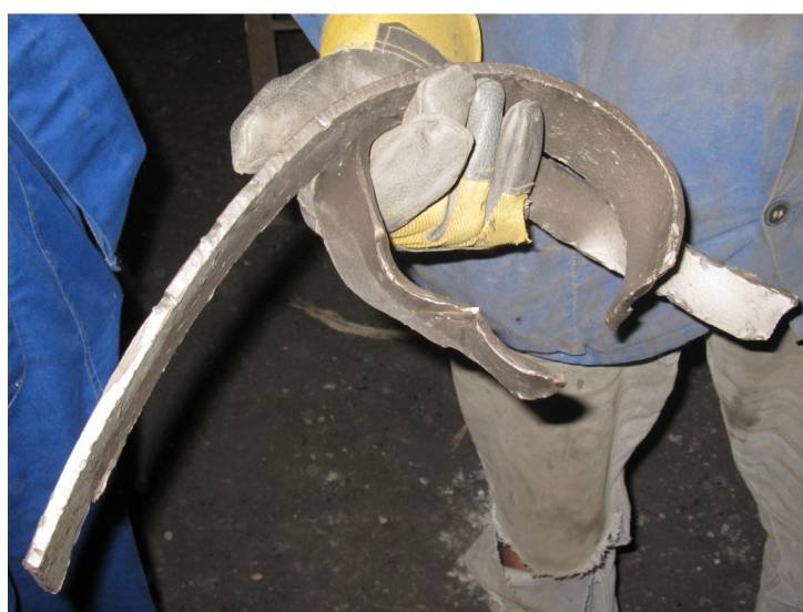
Rys. 7. 10a Metalowe elementy wyciągnięte z młyna nr 2 podczas jego przeglądu.
