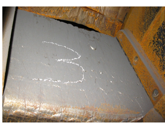
Małe zużycie krawędzi tnącej i bijaków
