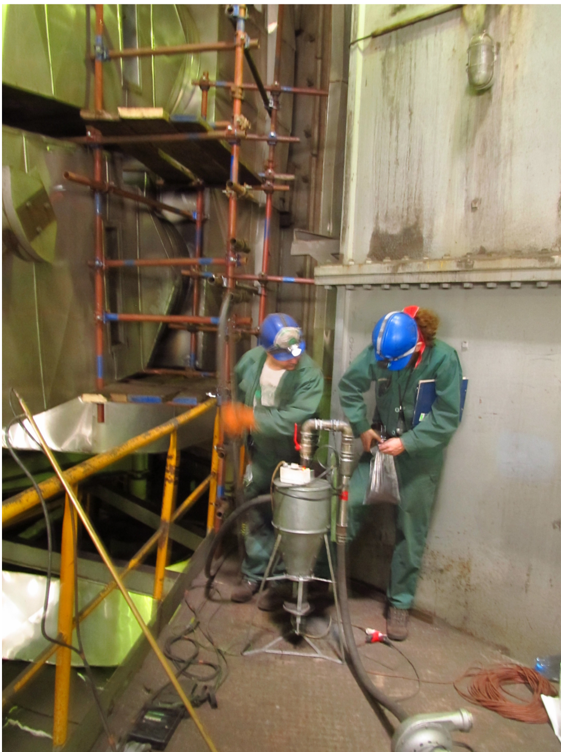
Rys. 5.1 Stanowisko pomiarowe do poboru pyłu w TE Kostolac w Serbii
