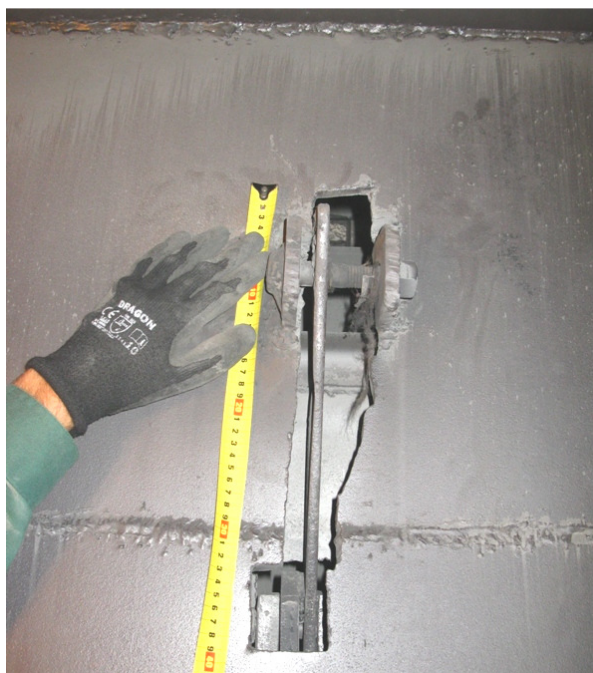
Rys. 7.9 Wycięcie w górnej łopacie odsiewacza młyna 3, przez które pył może się przedostawać na wylot z odsiewacza bez zawracania na łopatach.
