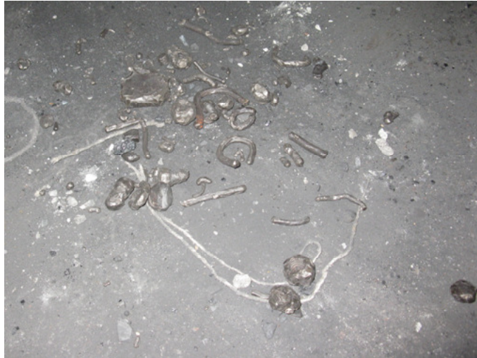
Rys. 7. 10b Metalowe elementy wyciągnięte z młyna nr 2 podczas jego przeglądu.
