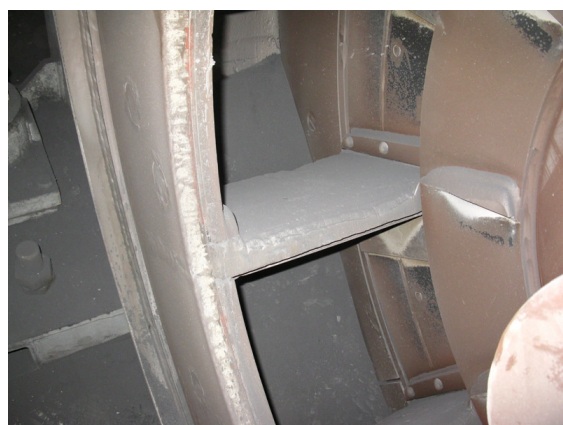
Małe zużycie krawędzi tnącej i bijaków
