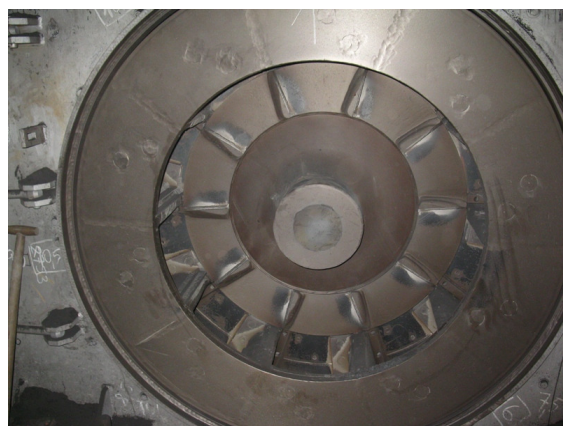
Małe zużycie krawędzi tnącej i bijaków
